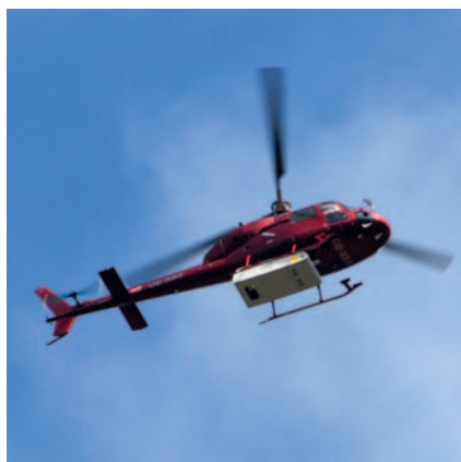
Lidar-Messung für digitales Oberflächenmodell.
